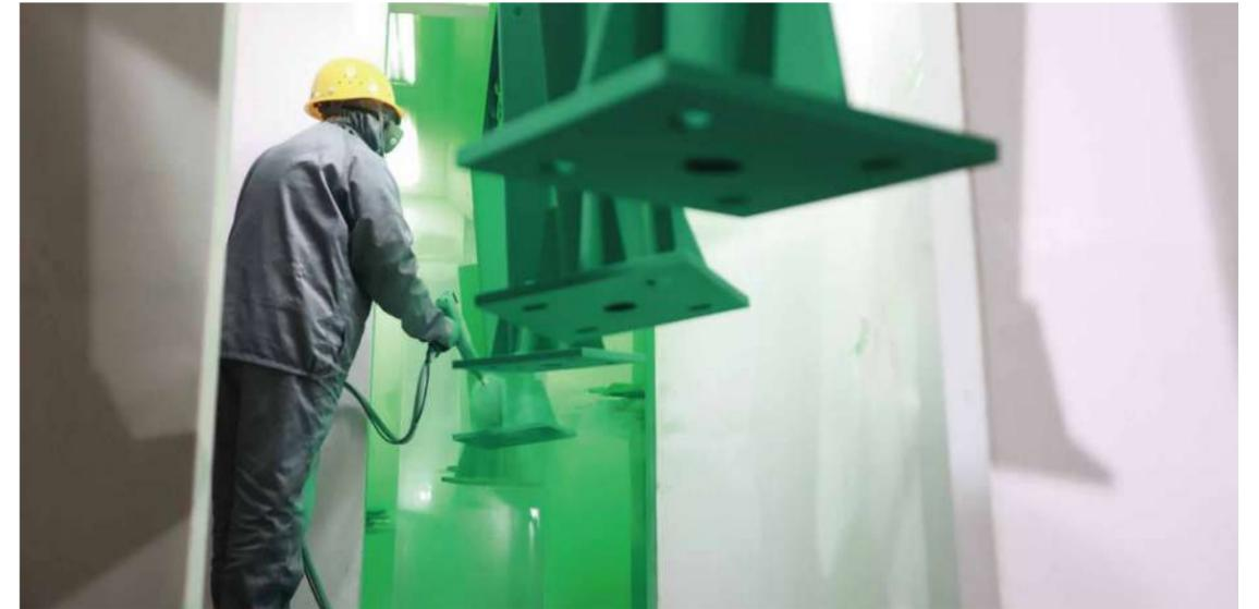
▲ 环氧锌基聚酯涂层护栏 Ограждение с полиэфирным покрытием на основе эпоксидной смолы и цинка
